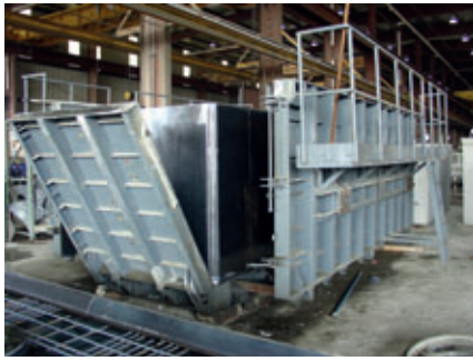
Figures 5, 6 et 7 : système de coffrage de Toyota sans démontage du noyau intérieur
